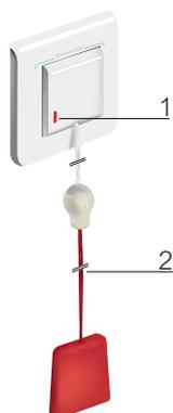
Peut-être positionné dans le volume 1 de la salle de bains et conseillé à 2,30 m de hauteur
