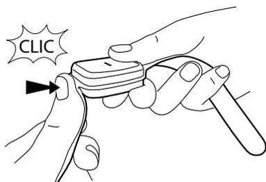
7 Vérifier que le bracelet est en place en tirant sur les extrémités : les ergots ne doivent pas ressortir.
